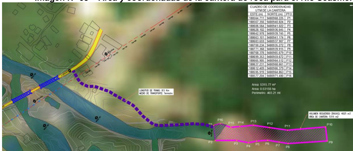
Imagen N° 05 – Área y coordenadas de la cantera de roca para el Río Seasme.
