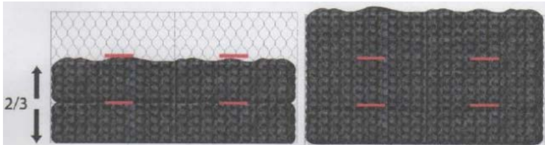
Gráfico N° 26 – Posición de los tensores en Gavión.
