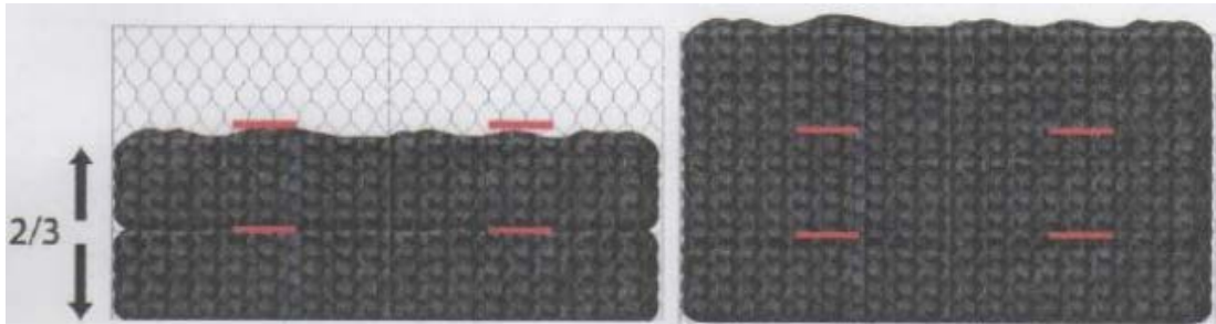
Gráfico N° 28 – Posición de los tensores en Gavión.
