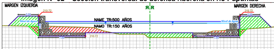
Imagen N° 02 – Sección transversal de defensa ribereña en río Pupuntas
